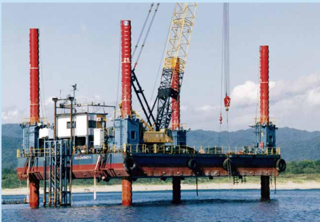
本船はレグφ1200mm・長さ44.0m・昇降能力400t×4基、計1,600tを有する作業台船で厳しい気象・海象下での作業が可能で、走行架台も設置できます。
